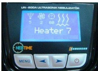
4. Premendo il tasto **MENU** di regolazione ancora una volta, apparirà la funzione **HEATER (RISCALDATORE)**, è il valore della resistenza del riscaldatore (livello del riscaldatore).
