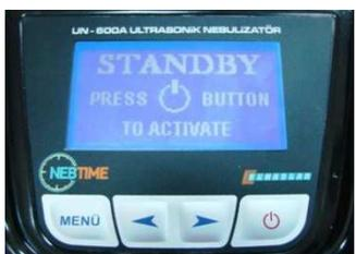
Terminato il tempo impostato dal **TIMER**, il dispositivo si spegne automaticamente ed entra in modalità **STANDBY**.
