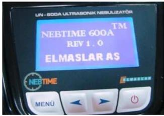
All'accensione del dispositivo NEBTIME MODELLO UN600A apparirà una scritta sullo schermo e inizierà la modalità di controllo automatico.
