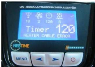
Se il cavo di collegamento del riscaldatore non sono collegati per qualche motivo, viene visualizzato sullo schermo il seguente errore "HEATER DISCONNECTED" cioè "CAVO RISCALDAMENTO SCOLLEGATO", controllare il collegamento del cavo.
