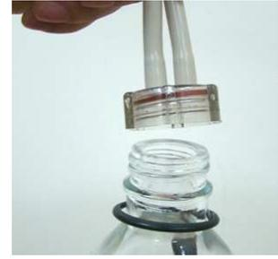
Mettere la bretella al collo della bottiglia, come illustrato nel disegno. Riempire la bottiglia con acqua sterile o demineralizzata. Posizionare ed inserire all'interno del tappo la guarnizione in silicone e avvitare il tappo sulla bottiglia.
