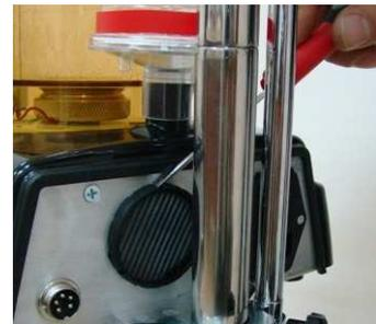
Sbloccare il copri-filtro ruotando in senso orario e estrarre il filtro danneggiato o esausto. Cambiare il filtro con uno nuovo inserirlo nell'alloggiamento e rimontare.
