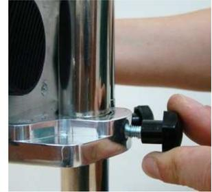
Collegare il tubo di gomma/silicone della bottiglia al portagomma piccolo situato sul coperchio della camera di nebulizzazione.
