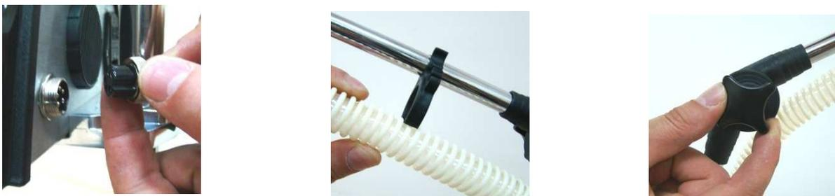
Inserire la presa del cavo del riscaldatore alla presa maschio del dispositivo situato sul lato posteriore (in caso di difficoltà durante il fissaggio, si prega di girare la presa a destra e a sinistra per ottenere la posizione corretta). Inserire il tubo corrugato lungo sui ganci del braccio. Regolare la posizione del braccio di supporto, allentando i bulloni a farfalla e poi stringendoli di nuovo.
