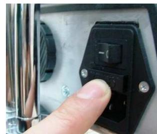
Se il dispositivo non funziona, controllare se i collegamenti del cavo elettrico, da entrambi i lati, sono inseriti correttamente nelle prese. Se il tasto ON / OFF del dispositivo è in posizione ON (acceso). Successivamente controllare il fusibile posto sulla presa di alimentazione 230V in ingresso del dispositivo.
