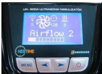
2. Premendo il tasto **MENU** di regolazione ancora una volta, apparirà la funzione **AIRFLOW, FLUSSO D'ARIA** (flusso dell'aria in uscita).
